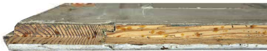
2. Oszlifowane czoło pionowej listwy drzwi przygotowane do pomiaru szerokości przyrostów rocznych. Fot. Zdzisław Nowakowski
