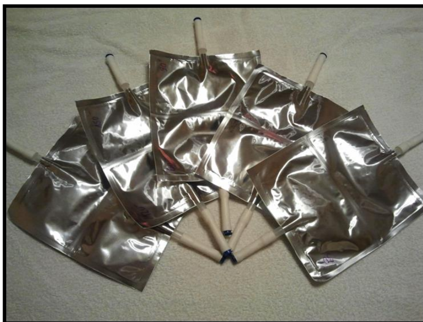
Rycina 5 Zestaw toreb do pobrania próbek powietrza
