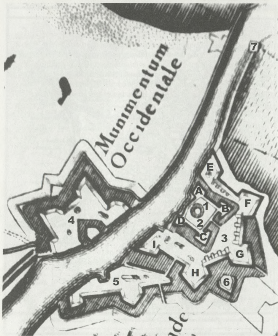
2. Twierdza Wisłójście według stanu z lat 1642-1648. 1 – Latarnia oraz Wieniec; 2 - Fort Carré; 3 – Szaniec Wschodni; 4 - Szaniec Zachodni; 5 – Szaniec Kleszy; 6 – rawelin; 7 - blokhauz; bastiony: A – Artyleryjski, B – Ostroróg, C – Południowo-Wschodni, D – Furta Wodna, E - Pucki, F - Ostroróg, G - Świński Łeb, H – Bielnik, I - Wiślany. Rys. na podkładzie ryciny z dzieła Pufendorfa, oprac. P. Maćkowiak
