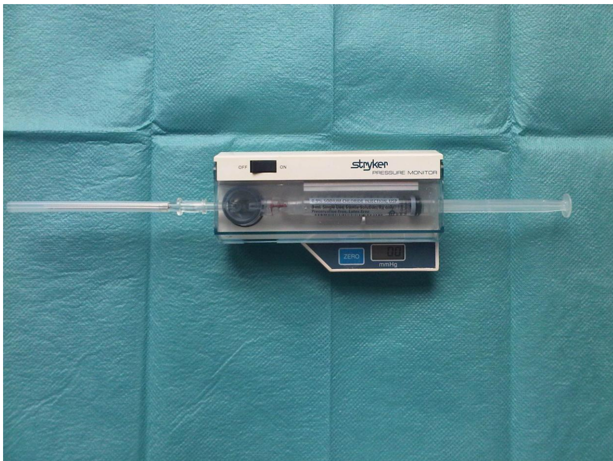
Ryc.8. Stryker Pressure Monitor. Aparat do krwawego, bezpośredniego pomiaru ciśnienia śródpowięziowego.
