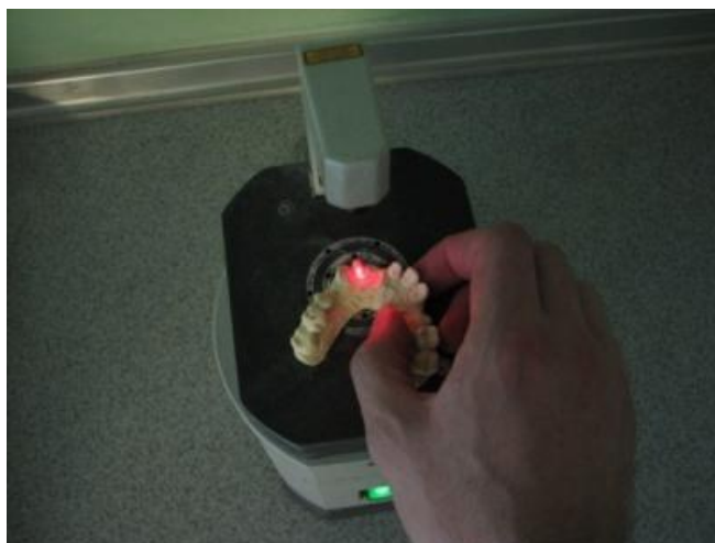
Rycina 4. Proces wiercenia otworów w modelu gipsowym za pomocą pinarki Renfert Top Spin Piny wklejono ściśle w otwory w łuku zębowym (Rycina 5).
