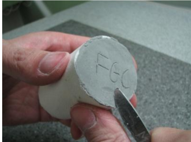
Rycina 11. Matowienie powierzchni formy skalpelem.
