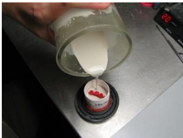
Rycina 10. Wypełnianie pierścienia płynną masą odlewniczą.
