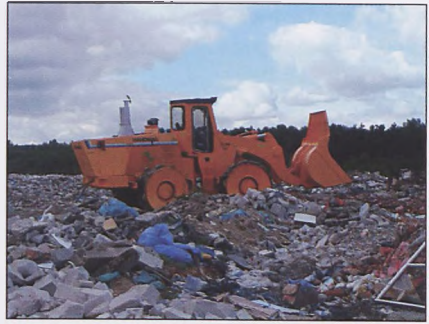
Kompaktor ugniatający odpady na składowisku. Ze zbiorów autorki
