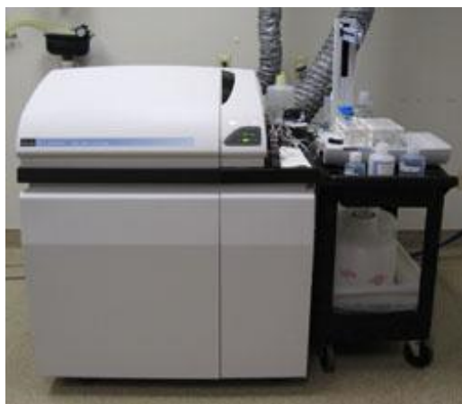
Rycina 19. Spektrometr mas ze wzbudzeniem w plazmie sprzężonej indukcyjnie (Spectrometer ELAN DRC-e Axial Field Technology, Perkin Elmer)
