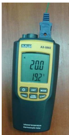
Rycina 7. Miernik temperatury AX 5002 Temp firmy Axiomet (dokładnością pomiaru \pm 0,1^{\circ}\text{C} ).
