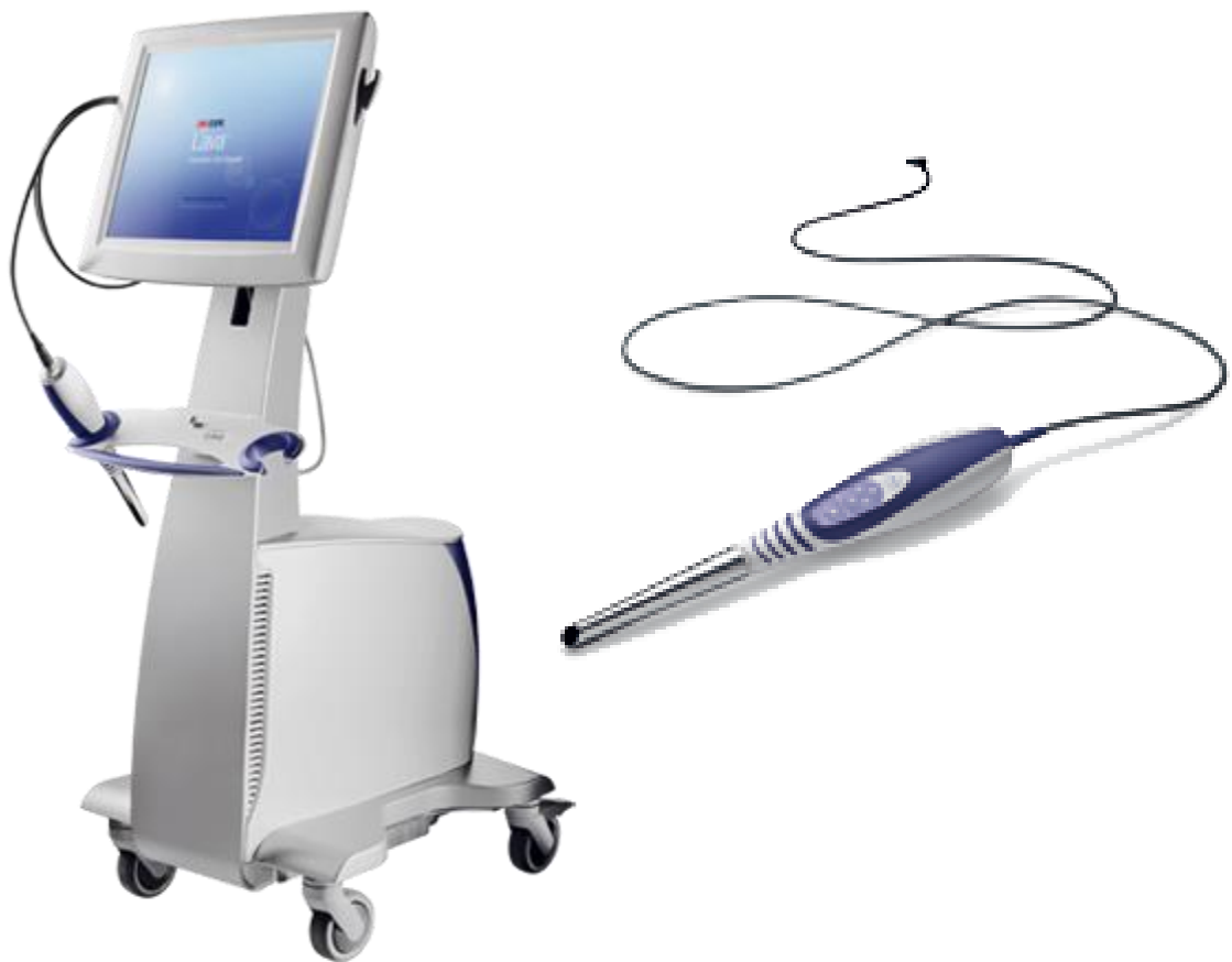
Rycina 13 Skaner wewnątrzustny LAVA C.O.S. (źródło: 3MEspe, USA)
