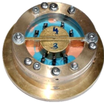
Rycina 30 Pobrane wyciski z przykręconymi do transferów analogami implantów, zamontowane w urządzeniu badawczym
