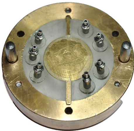
Rycina 28 Zamontowane w urządzeniu badawczym modele „0” z implantami ustawionymi zbieżnie (0-4-z i 0-3-z) z zamontowanymi transferami do łyżki otwartej
