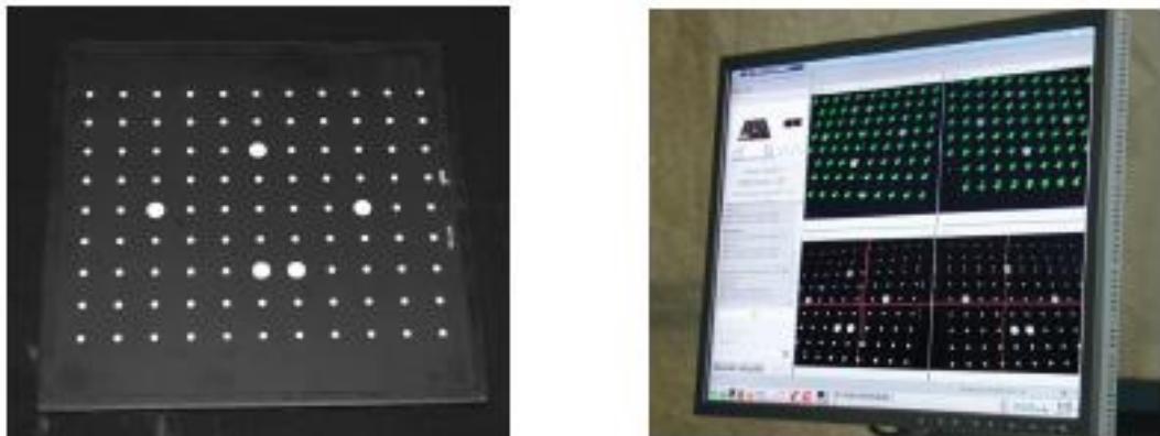
Rycina 56 Płyta wzorcowa GOM (z lewej) i widok płyty w oprogramowaniu (z prawej)
