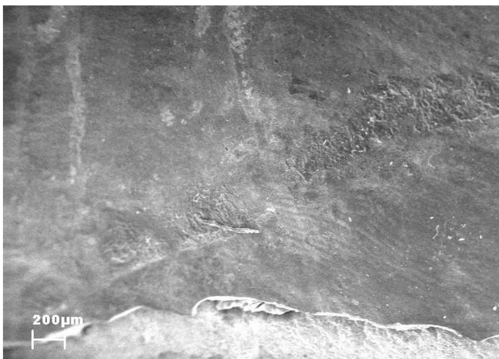
Fot. 4. Zdjęcie w mikroskopie elektronowym skaningowym fragment u zęba uszkodzonego w powiększeniu 200 x 13
