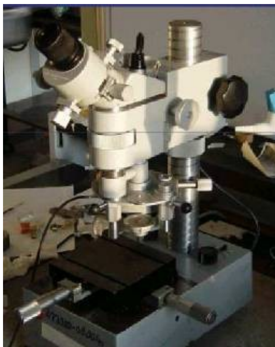
Ryc. 3. Mikrotwardościomierz Durimet – 2 K
