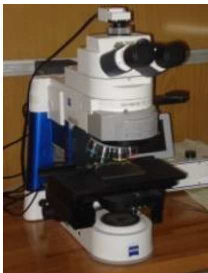
Ryc. 7. Mikroskop metalograficzny optyczny AXIOIMAGER. M1m
