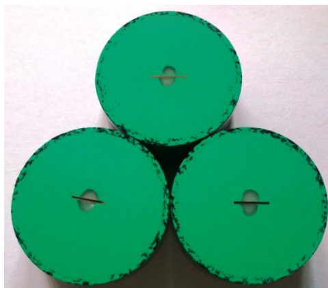
Ryc. 11. Zainkludowane próbki przeznaczone do oceny mikrostruktury.
