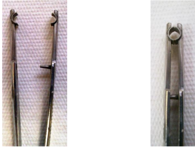
Ryc. 8. Matryca przeznaczona do formowania warstw ceramicznych.
