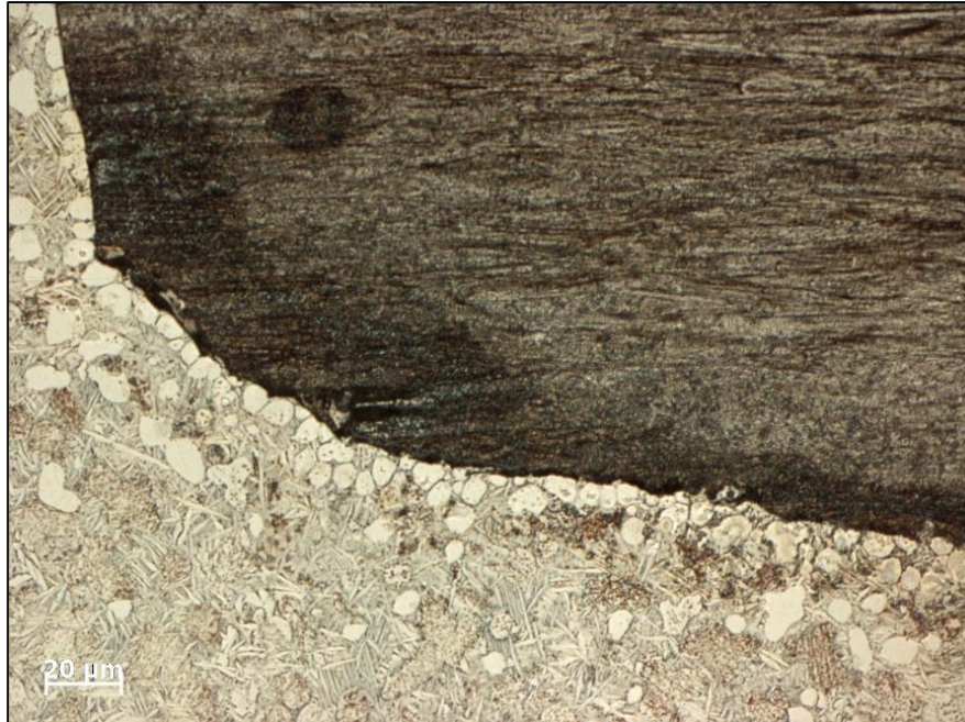
Ryc. 41. Na zdjęciu widoczne procesy korozyjne w postaci ciemnych plam w strukturze drutu ortodontycznego Remanium 0.8 mm , powiększenie x 500 (zgląd trawiony).
