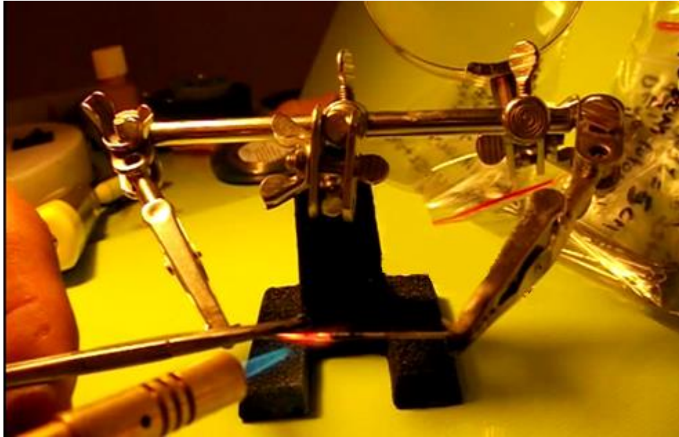
Ryc. 6. Ogrzewanie palnikiem drutu Dentaurum 0,8 mm po nałożeniu topnika Dentaflux. Odległość płomienia od lutowanej powierzchni. wynosiła max 3 mm.
