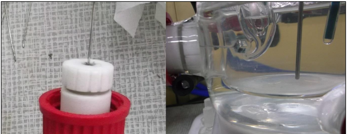
Ryc. 25. Elektroda badawcza, (drut Remanium 0,8 mm lutowany z pierścieniem Dentaurum) oraz jej położenie w naczyniu pomiarowym względem kapilary Ługgina.
