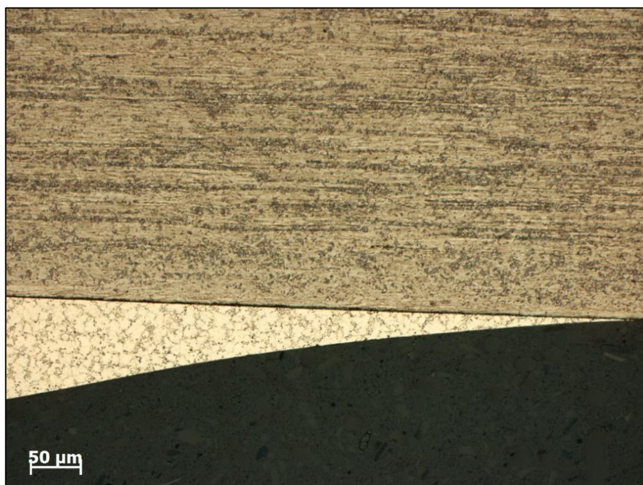
Ryc. 38. Prawidłowe połączenie lutowia z drutem Remanium 0.8 mm przed ekspozycją w roztworze sztucznej śliny, powiększenie x 200 (zgląd trawiony).
