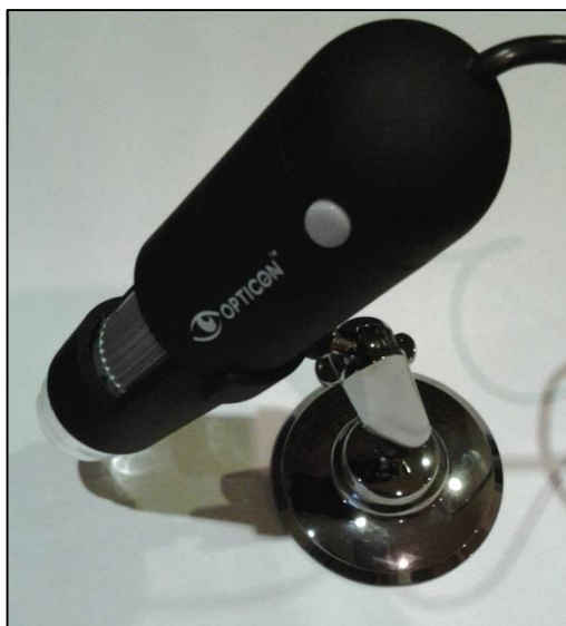
Ryc. 8. Mikroskop Opticon wykorzystany do oceny, jakości połączeń lutowanych.
