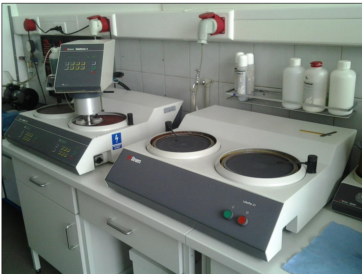
Ryc. 14. Stanowisko do szlifowania próbek na tarczach obrotowych firmy Struers.
