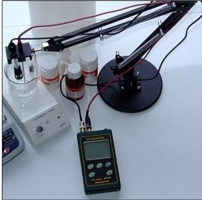
Ryc. 19. Na zdjęciu przedstawiono pH metr Elmeiron CPC – 411, który służy do pomiarów pH sztucznej śliny.
