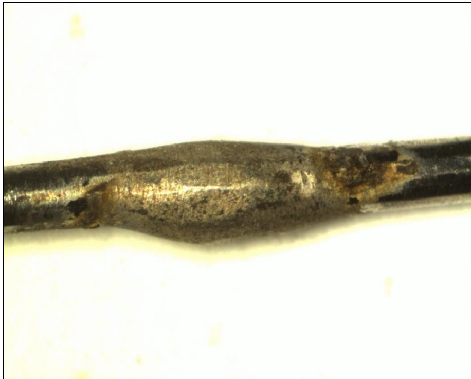
Ryc. 31. Doczołowo lutowany drut Remanium 0.8 mm po trzymiesięcznej ekspozycji w roztworze sztucznej śliny powiększenie x 10.
