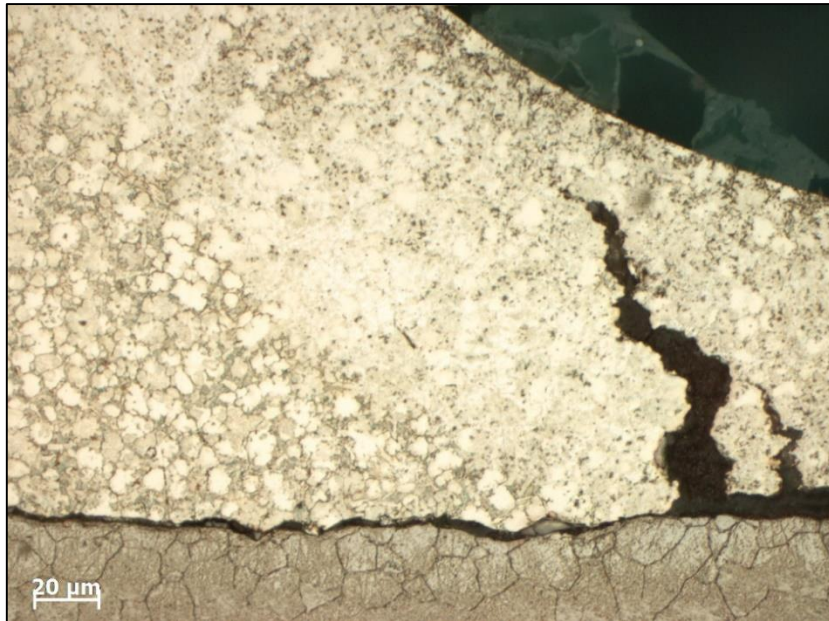
Ryc. 57. Lutowane połączenie między drutem Remanium 0,8 mm, a pierścieniem Dentoform bez zamka, przed ekspozycją w roztworze sztucznej śliny, powiększenie x 500 (zgląd trawiony).
