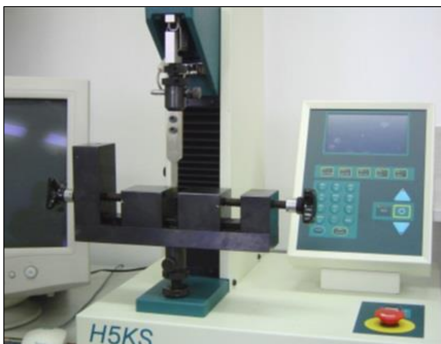
Ryc. 12. Uniwersalna maszyna testująca Hounsfield H5 KS.
