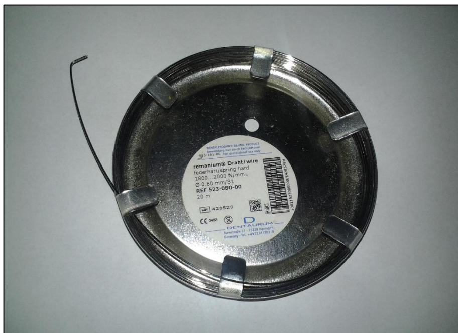
Ryc. 1. Drut ortodontyczny Dentaurum Remanium o średnicy 0,8 mm (REF 523-080-00).
