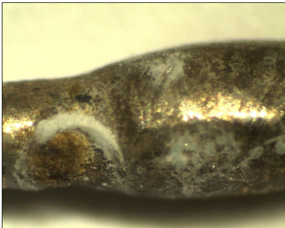
Ryc. 34. Doczołowo lutowany drut Remanium 0.8 mm po trzymiesięcznej ekspozycji w roztworze sztucznej śliny powiększenie x 50.
