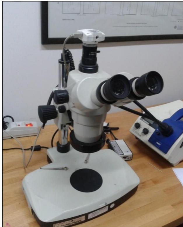
Ryc. 16. Mikroskop stereoskopowy SMZ 168 firmy Hahn-Kolb.
