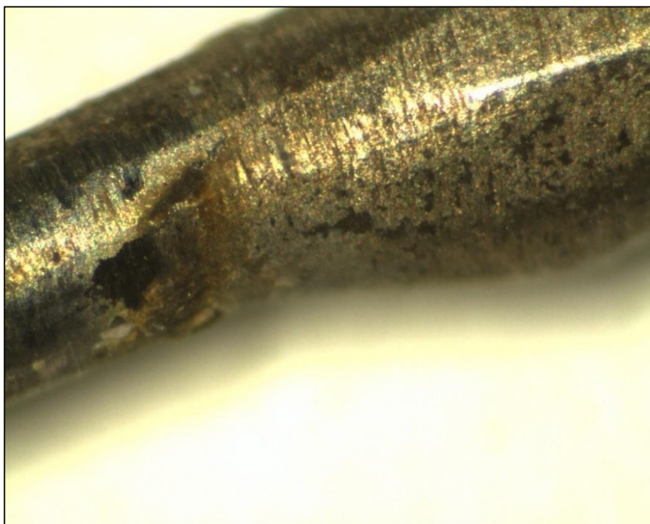
Ryc. 32. Doczołowo lutowany drut Remanium 0.8 mm po trzymiesięcznej ekspozycji w roztworze sztucznej śliny powiększenie x 50.
