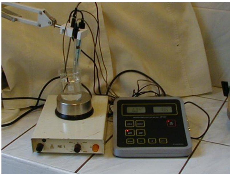
Ryc. 1 Zestaw pomiarowy do określania potencjałów elektrogalwanicznych stopów protetycznych (badania wstępne, etap I).
