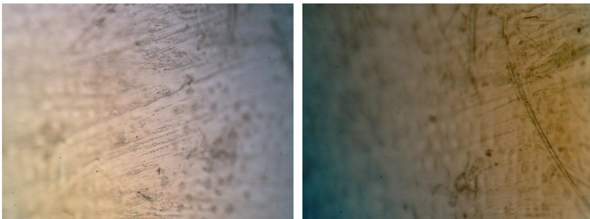
Ryc. 25 i 26 Stop Remanium GM 800 po 30-minutowym polerowaniu – 17 i 29 \mu\text{m} (mikroskop metalograficzny).
