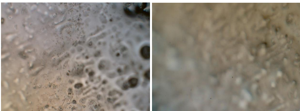
Ryc. 28 i 29 Stop Biosil f po 5-minutowym polerowaniu – 0 i 11 \mu\text{m} (mikroskop metalograficzny).
