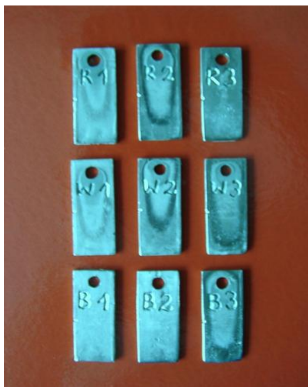
Ryc. 5 Próbki stopów wykorzystanych w badaniach in vitro : Wironit extrahart (W), Remanium GM 800 (R) oraz Biosil f (B) po elektropolerowaniu przez 5 (1) lub 15 (2) lub 30 (3) minut.
