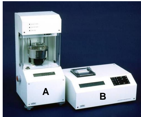
Fot. 13. Tensjometr K12 służący do pomiaru równowagowego napięcia powierzchniowego metodą oderwania pierścienia du Noüy'a: A – jednostka mierząca, B – jednostka rejestrująca
