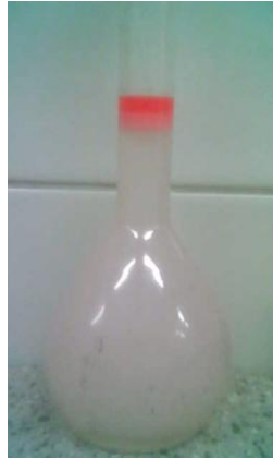
Fot. 16. Roztwór proszku do prania w kolbie miarowej (200 ml) po procesie emulgowania Źródło: badania własne
