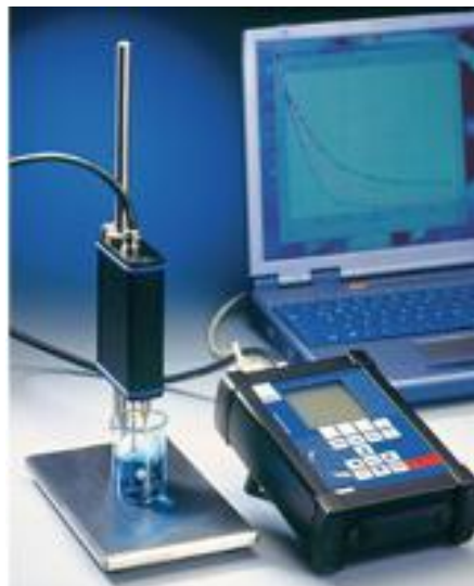
Fot. 14. Tensjometr SITA t60 do pomiaru dynamicznego napięcia powierzchniowego Źródło: http://www.online-tensiometer.com/produkte/t60/science_line_t60.html
