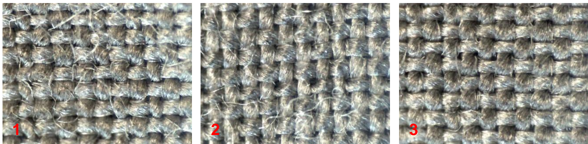
Fot. 20. Struktura włókien tkanin EMPA 101 (100% bawełna) po procesie prania w wodzie dejonizowanej o twardości 5,35 mval/l (3 próbki)
