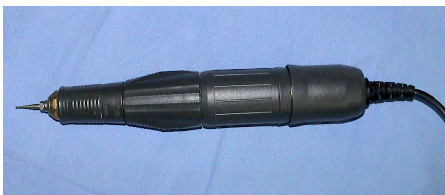
Rycina 6. Wiertarka wysokoobrotowa z wiertłem o średnicy 1 mm używana do wykonywania laminektomii lędźwiowej.
