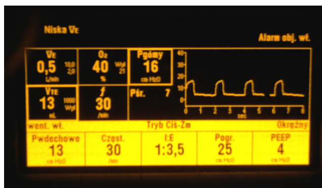
Ryc. 5. Zapis z monitora aparatu do znieczulenia Ohmeda Aespire 7900 przedstawiający parametry wentylacji podczas zabiegu (wł. autorki).
