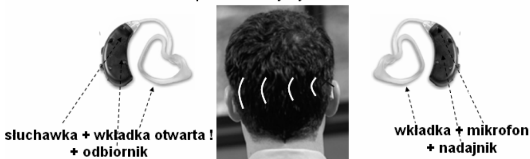
Ryc. 20. Schemat przedstawiający działanie CROS.
