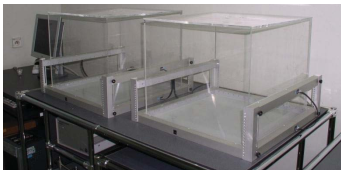
Rycina 2. Aparat TSE ActiMot do pomiaru aktywności ruchowej zwierząt.
