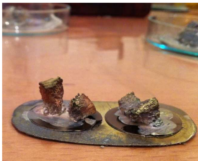
Fot. 1 Próbki kości przygotowane do oceny w elektronowym mikroskopie skaningowym
