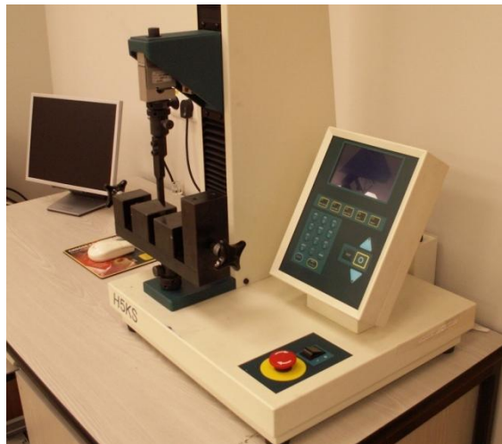
Ryc. 15 Urządzenie badawcze Hounsfield H 5 KS
