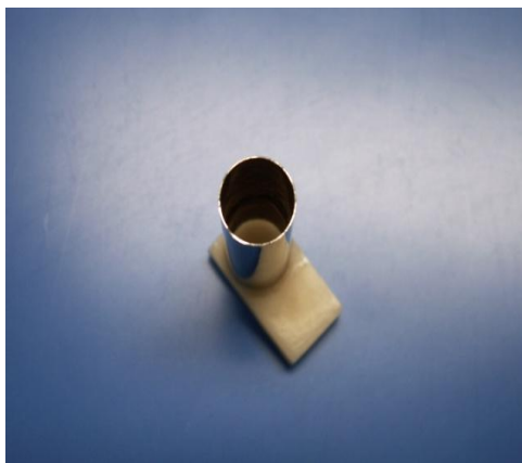
Ryc. 6 Metalowa matryca przyklejona do próbki acetalowej
