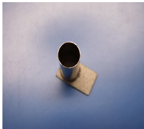
Ryc. 7 Metalowa matryca przyklejona do próbki ze stellitu
