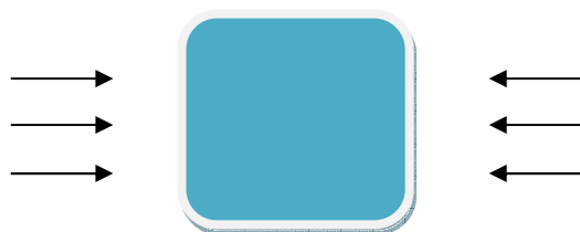
Ryc. 7. Schemat przedstawiający metodę dwustronnego napromienienia.
