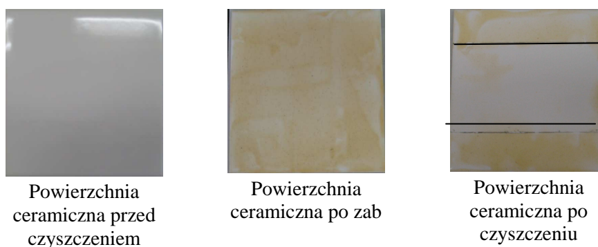
Rys. 66 Skuteczność usuwania zabrudzenia typu I z powierzchni ceramicznej przez pastę P24. Wpływ estrów metylowych kwasów tłuszczowych.
