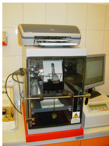
Rys. 13 Schemat jednostki mechanicznej i zdjęcie aparatu HFRR, 1 - próbka górna, 2 - blok grzejny, 3 - próbka dolna, 4 - termometr, 5 - przetwornik siły.
