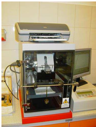
Rys. 49 Tester HFRR realizujący ruch posuwisto zwrotny o wysokiej częstotliwości.
