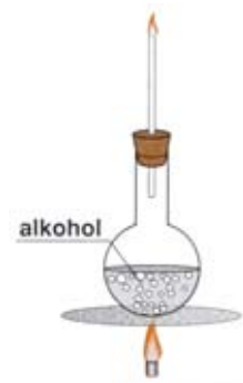
Rys. 23. Wykrywanie alkoholu etylowego w winie
