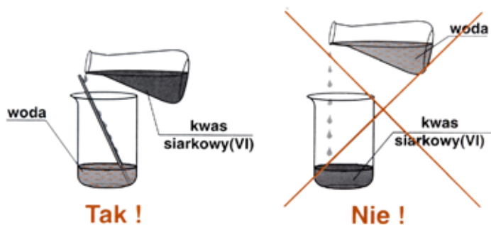
Rys. 3. Prawidłowy i nieprawidłowy sposób rozcieńczenia kwasu siarkowego(VI) wodą
