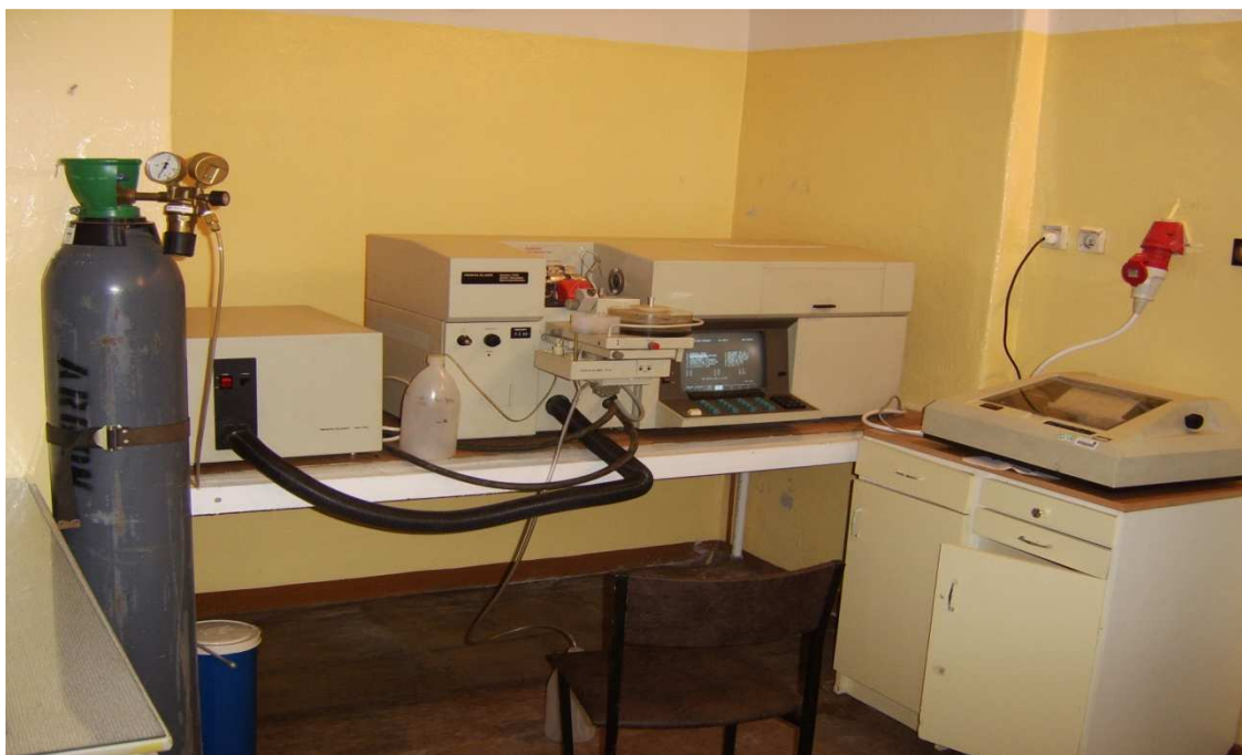
Rycina 1. Aparat do pomiarów atomowej spektroskopii absorpcyjnej Perkin-Elmer Zeman 3030
