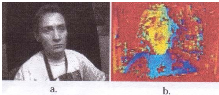
Rysunek 12. Klatka 12(lewa) sekwencji stereo (a), i obliczona różnica obrazu(b).
