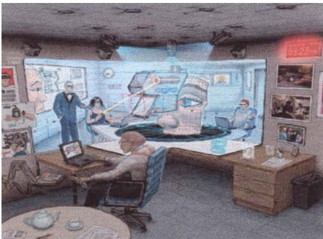
Rys 2 Poglądowy rysunek biura przyszłości (realne obiekty na rysunku i wyświetlany obraz). Przez zastąpienie normalnych świateł biurowych projektorami, dzięki jednemu projektorowi można uzyskać dokładną kontrolę nad całym światłem w biurze. Z pomocą zsynchronizowanych kamer, geometrii
